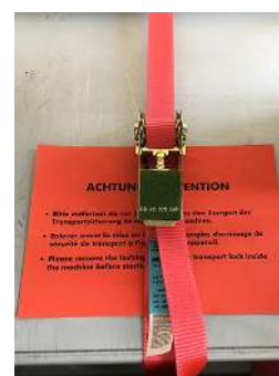
Serrure de transport avec sangle d'arrimage
